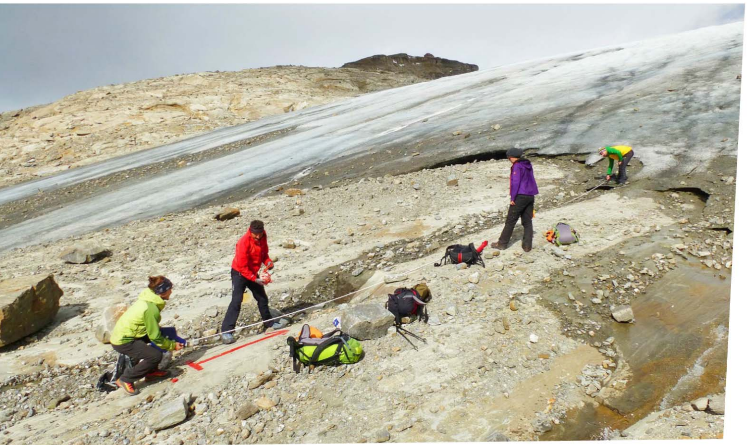
Traditionelle Maßbandmessung der Längenänderung des Wasserfallwinkelkeeses, eines Nachbargletschers der Pasterze, im Jahr 2015. | Foto: Lieb
