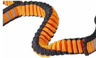
TYP „Harmonica“ = verringerte Lebensdauer >> Austausch der Karabineräste
