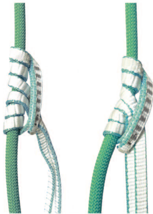
Abb. 3 FB-Prusik mit zusätzlicher Wicklung. Wie beim klassischen Prusik mit einer Reepschnur, ist abhängig von den Durchmessern eine zusätzliche „dritte“ Umwicklung notwendig, um genügend Reibung bzw. Klemmwirkung zu erreichen. Gleiches gilt für den FB-Prusik, der i.A. dann optimal hält, wenn die Länge der Naht mit Umwicklungen ausgefüllt wird.
