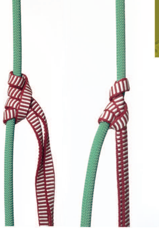
Abb. 2 Konventioneller Prusik mit Bandschlinge ohne Einbeziehung der Doppelung an der Naht. Links unbelastet und rechts unter Belastung: der Knoten verklemmt sich stärker und ist dann schwieriger zu lösen bzw. zu verschieben wie der FB-Prusik.
