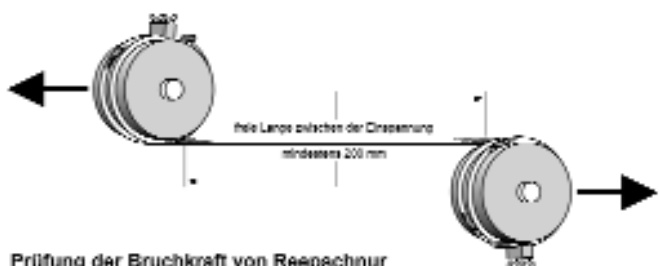
Prüfung der Bruchkraft von Reepschnur
