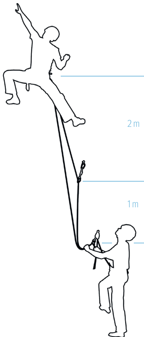
Abb. 1 Aufbau Sturzversuche bei Halbseiltechnik.
